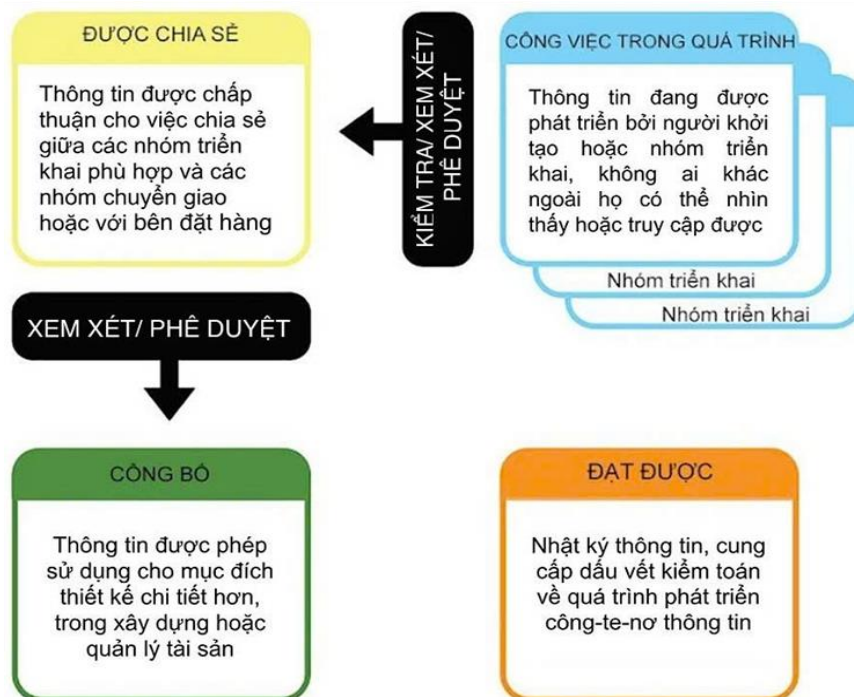
Hình 16. Diễn giải hình 10 của TCVN 14177-1:2024 (biên soạn căn cứ theo ISO 19650-1:2018) về khái quát nguyên tắc cơ bản của môi trường dữ liệu chung
