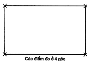
Hình 16- Các điểm đo khi xác định độ vuông góc bằng phép đo chéo
