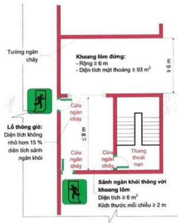
e) Khoảng đệm không nhiễm khói là một sảnh có thông gió tự nhiên với khoang lờm
