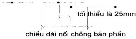
Hình F.2 – Chiều dài nối chồng lưới cốt thép cho ví dụ 2
