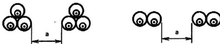
**CHÚ THÍCH 1:** Các giá trị đưa ra áp dụng cho hệ thống lắp đặt ở độ sâu 0,7 m và nhiệt trở đất bằng  $2,5 \text{ }^{\circ}\text{C.m/W}$ . Chúng là các giá trị trung bình của dải các cỡ cáp và loại được trích dẫn cho Bảng B.52.2 đến B.52.5. Qui trình lấy trung bình cùng với làm tròn, trong một số trường hợp có thể gây ra sai số đến  $\pm 10\%$ . (Trong trường hợp yêu cầu các giá trị chính xác hơn, có thể tính theo phương pháp nêu ở IEC 60287-2-1.)
